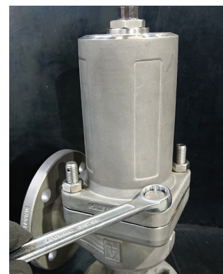
Verschraubung von Haube und Gehäuse.
