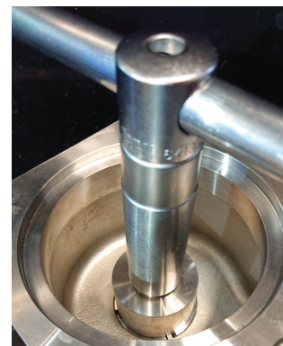
Einschrauben des Sitzes in das Gehäuse.
