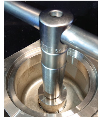
Einschrauben des Sitzes in das Gehäuse.
