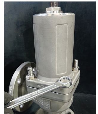
Verschraubung von Haube und Gehäuse.
